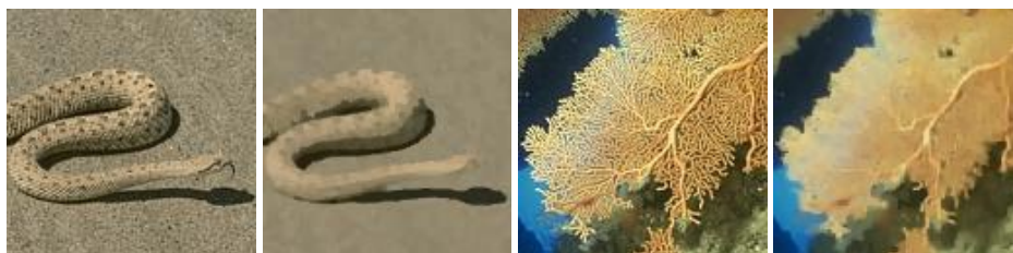
Fig. 2. Filtrado iterativo del filtro 4-conectado. De izquierda a derecha y de arriba abajo: imagen original e imágenes resultantes después de aplicar el filtro iterativamente 3, 10 y 25 veces respectivamente
